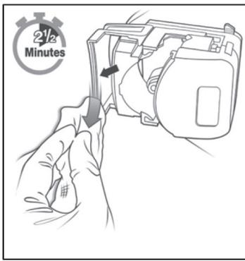
Figure 10. Essayer le joint de fermeture.
